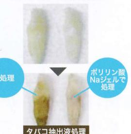
タバコ抽出液に一晩浸することで汚れを付着させた前歯を、ポリリン酸Na配合ジェルで30分間（37℃）処理した後軽く水洗いした結果。
